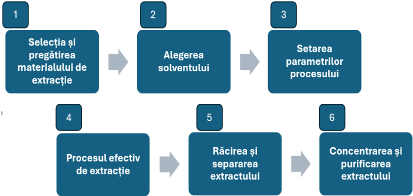
Figura 19. Schema de extracție prin microunde
